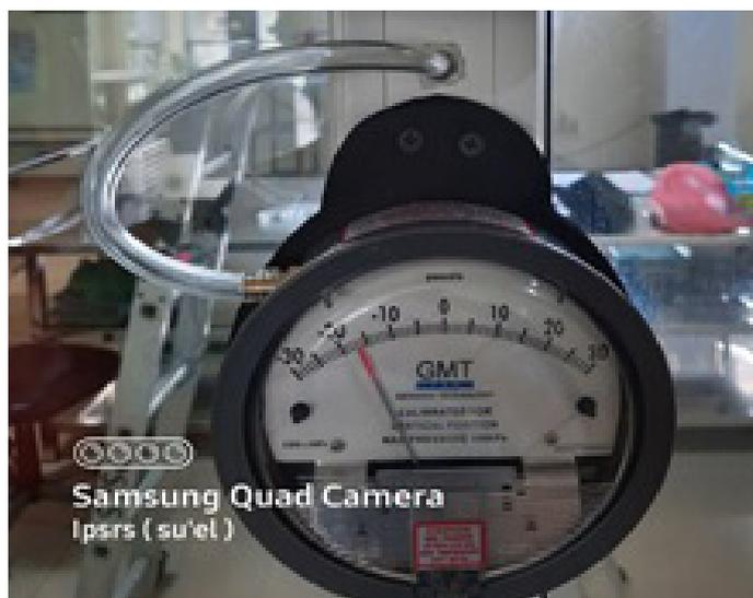
Negatif Pressure Ruang Dekontaminasi CSSD Menggunakan alat Ukur Differential Pressure gauge / *magnahelic* sebesar - 15 Pa
